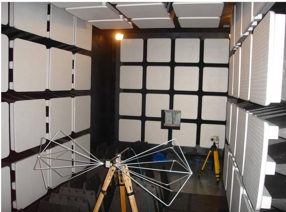
La camera è altresì dotata di telecamera schermata fino a 200 V/m per visualizzare l'oggetto in prova durante l'esecuzione del test di immunità, con collegamento a monitor esterno televisivo in fibra ottica.
